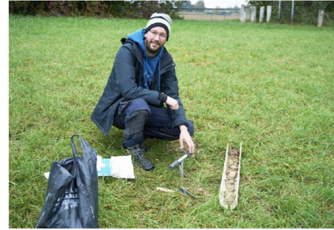
Mardi 19 octobre 2021, E. Chanez – Caractérisation du sol par un sondage à la tarière
